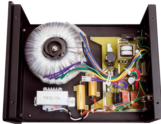
Das ausgelagerte Netzteil mit Trafo, Drosselspule und Gleichrichterschaltung
