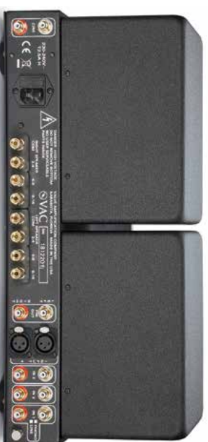
► Massive Buchsen an der Rückseite und getrimmte Abgriffe für Lautsprecher mit vier, acht oder 16 Ohm Nennimpedanz, die gefährlich ausprobiert werden können
