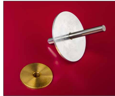
Die recht dünne Edelstahlachse dreht sich auf einer Stahlkugel in der Buchse
